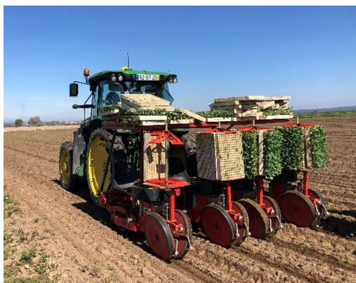
Figura 5- Pormenor do plantador de brócolo de 4 linhas.
